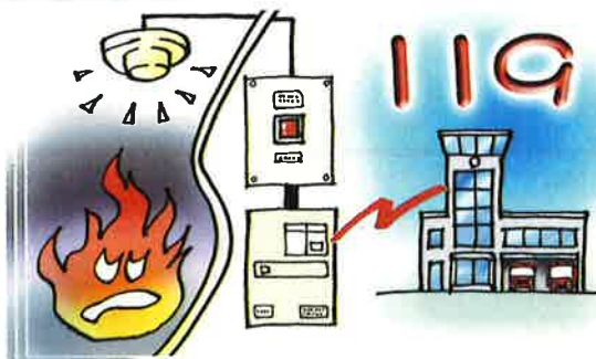
自動火災報知設備の作動と 連動した火災通報装置
